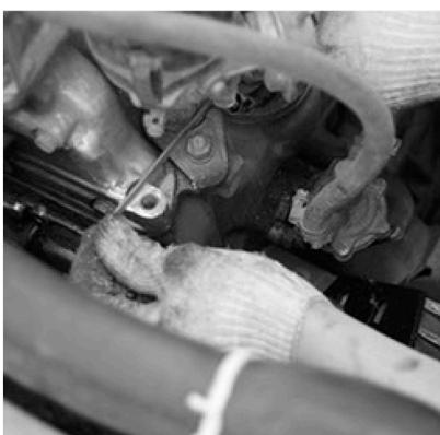
3) Теперь берем болгарку или напильник и подтачиваем блок двигателя для верхнего крепления кронштейна (болт слева от трамблера, если стоят у водительского крыла). На блоке прилив имеет окружную форму, мы же ее приводим к прямоугольной!
