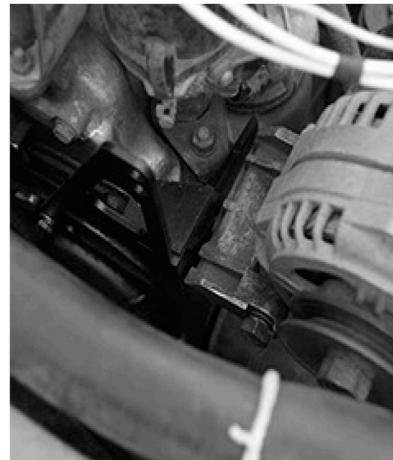
6) Отсоединяем "-" от АКБ, снимаем ремень с генератора, отсоединяем провода от старого генератора. Расплетаем кусок проводки от нижнего генератора до уровня самой АКБ и эл. мотора дворников (мне такой длины хватило, чтобы дотянуть до верхнего генератора) Упаковываем проводку в гофр.
