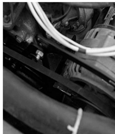
7) Устанавливаем генератор на верхний кронштейн, одеваем ремень. Проверяем соосность шкивов. При необходимости регулируем положение кронштейна генератора. Устанавливаем натяжную планку. Натягиваем ремень генератора!
